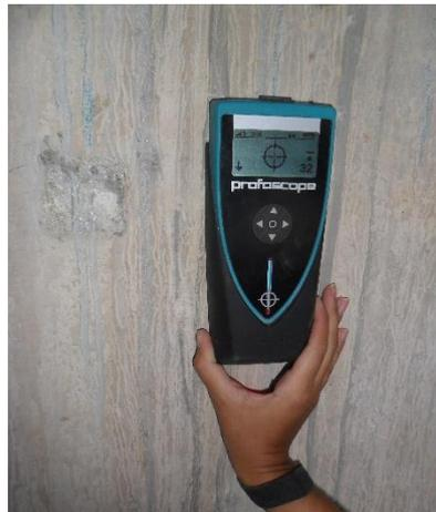
Figura 2: Localização da armadura no concreto e seu cobrimento por meio de pacometria.
