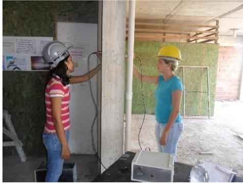
Figura 1: Ensaio de ultrassom, com os transdutores posicionados de forma direta.
