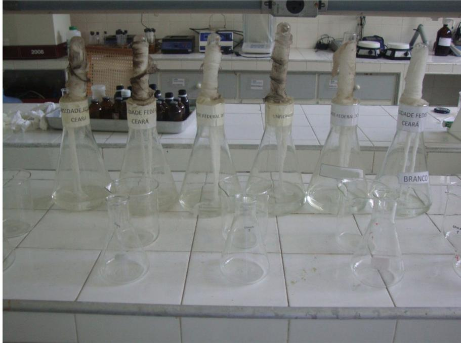
Figura B.1 - Velas coletas (da esquerda para direita: E1, E2, E3, E4, UFC e BRANCO)
