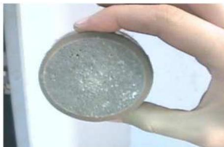
Figura 3.17 – Camada impermeabilizante de resina
