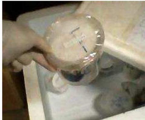
Figura 3.24 – Colocação do recipiente, contendo o corpo de prova, anel e papel filtro na caixa de isopor
