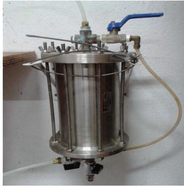
Figura 3.8 – Reservatório de aço inox
