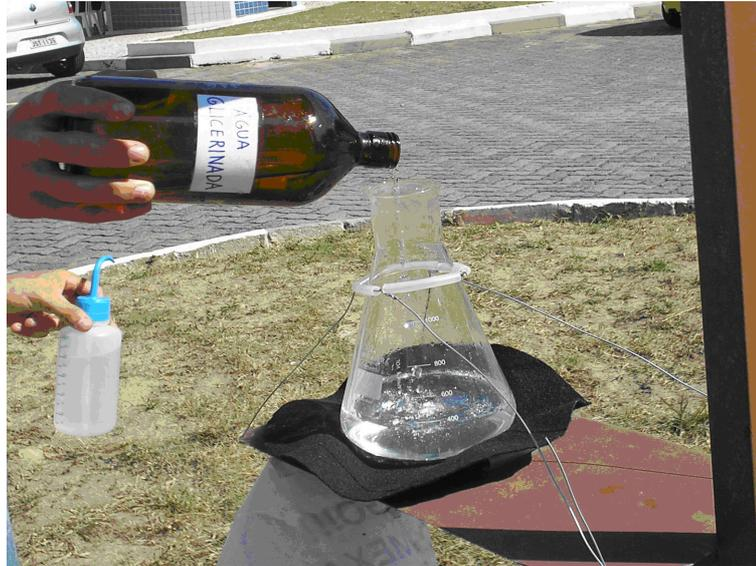
Figura 3.38 – Introdução da água glicerinada no frasco coletor
