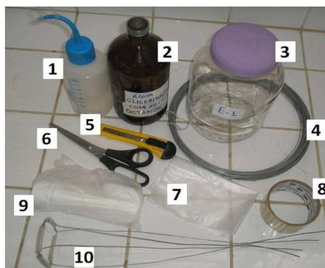
Figura 3.34 – Materiais utilizados para a realização da coleta da vela úmida, “kit vela”
