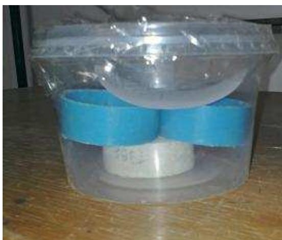
Figura 3.23 – Recipiente devidamente lacrado, provido do papel filtro, anel de PVC e do corpo de prova
