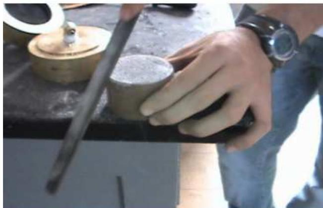
Figura 3.19 – Abaulamento da base e topo do corpo de prova de argamassa
