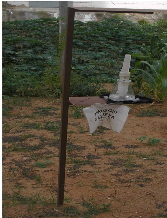
Figura 3.27 – Suporte da vela úmida fixado no solo
