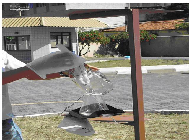
Figura 3.35 – Coleta da vela úmida
