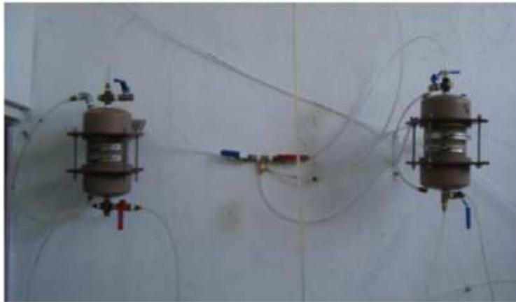
Figura 3.6 – Reservatórios - Interface ar/solução
