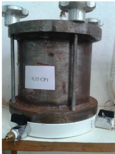
Figura 3.15 – Permeâmetro fechado contendo no seu interior uma fatia do concreto dosado com a/c igual a 0,55
