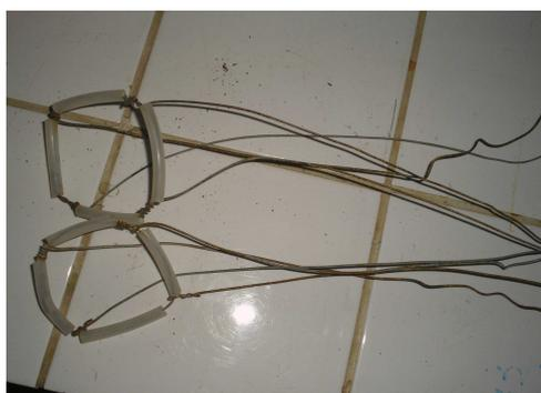
Figura 3.30 – Haste de aço galvanizado oxidado
