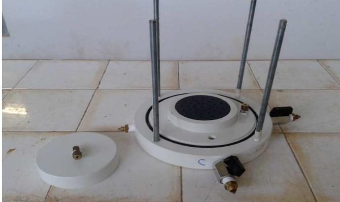
Figura 3.13 – Parte interna do equipamento (desprovido da mangueira que faz ligação com o topo)
