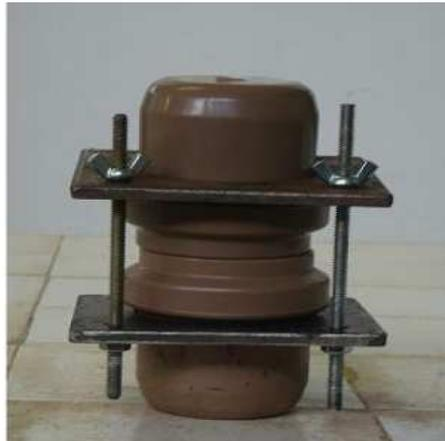
Figura 3.10 – Cap de PVC JE PBA empregado em corpo de prova de argamassa com 10 cm de altura
