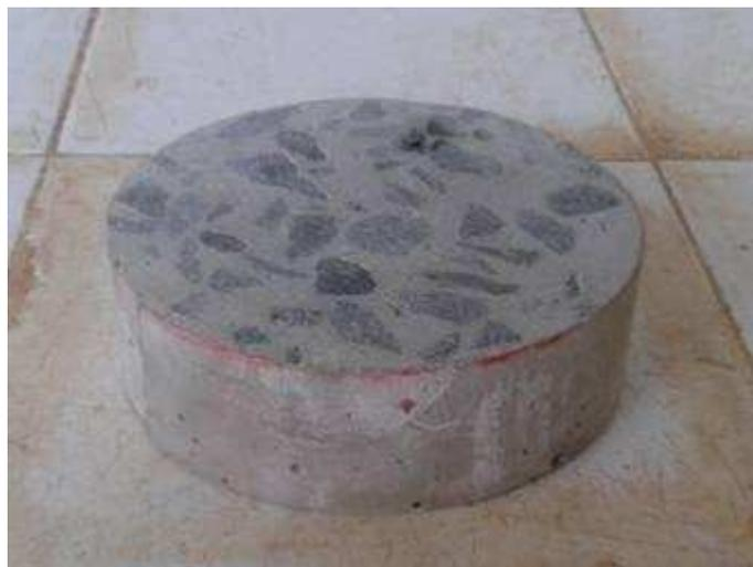
Figura 3.20 – Fatia de corpo de prova de concreto tratado com parafina na sua superfície lateral
