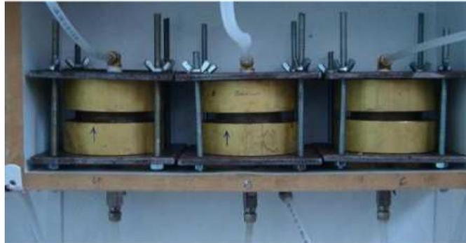
Figura 3.11 – Câmara de latão para corpos de prova de 4 cm de altura
