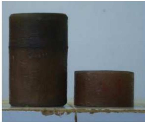
Figura 3.18 – Corpos de prova de argamassa com 4 e 10 cm de altura
