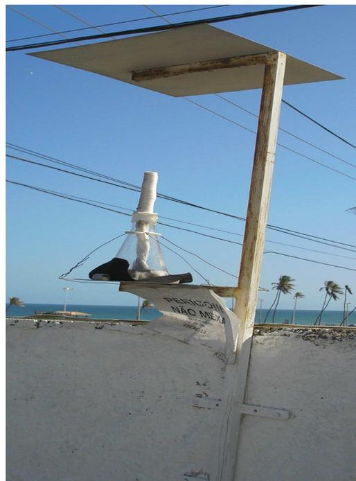
Figura 3.28 – Suporte da vela úmida fixado na parede
