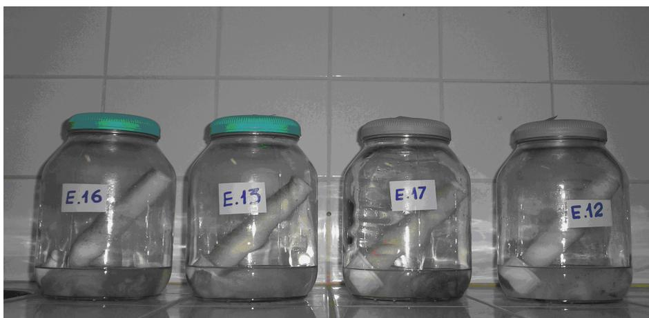
Figura 3.40 – Frascos coletores com suas respectivas identificações, contendo a vela coletada
