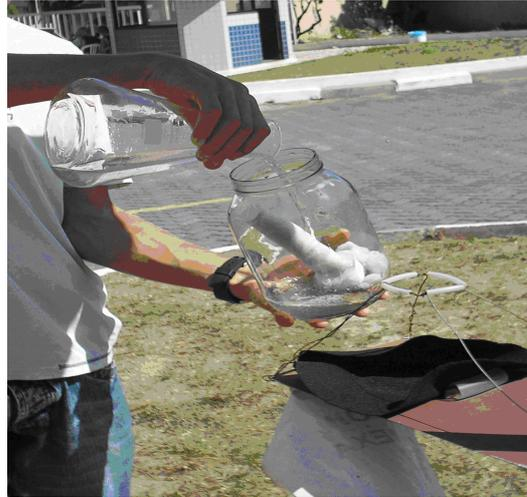
Figura 3.36 – Coleta da solução do frasco coletor
