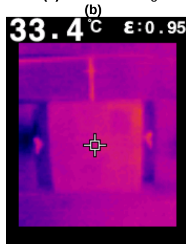
Figura 5.16 — Imagens do ensaio de termografia: (a) Luz visível. (b) Câmera termográfica.
