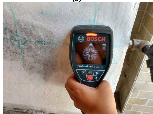
Figura 5.14 — Scanner – Detector de Materiais (a) Leitura total. (b) Leitura parcial. .
