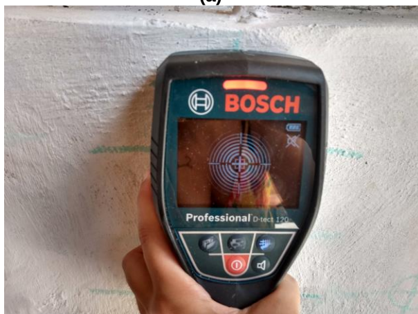
Figura 5.14 — Scanner – Detector de Materiais (a) Leitura total. (b) Leitura parcial. .
