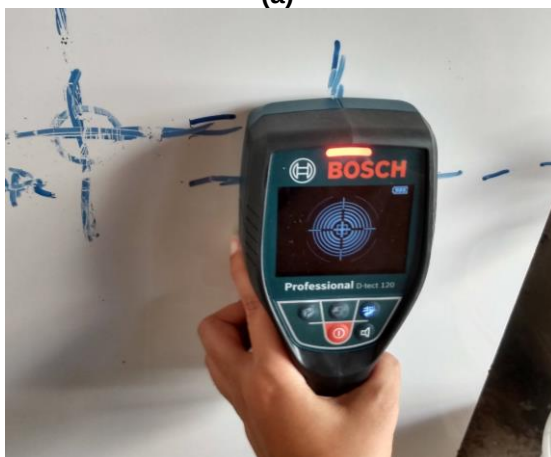
Figura 5.5 — Scanner – Detector de Materiais (a) Leitura total. (b) Leitura parcial. .
