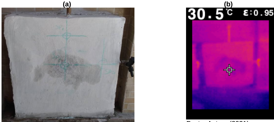
Figura 5.23 — Imagens da 10ª medição: (a) Luz visível. (b) Câmera termográfica. .
