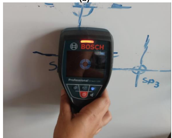
Figura 5.5 — Scanner – Detector de Materiais (a) Leitura total. (b) Leitura parcial. .
