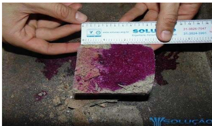
Figura 20 - Ensaio de profundidade de carbonatação
