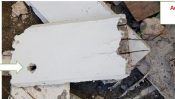
(g) ferragens de armadura da placa em aço carbono comum corroidas nas faces que não possuíam recobrimentos adequados, mas inteiras nas regiões devidamente cobertas.
