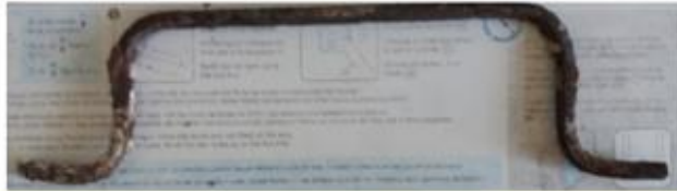
(f) gancho de ferro comum usado na ancoragem com pouca corrosão superficial após 40 anos de desempenho.
