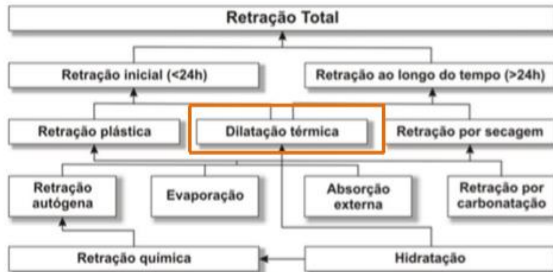
Figura 1 - Esquema dos mecanismos que governam os tipos de retração incidentes sobre o concreto (adaptado de ESPING, 2007).
