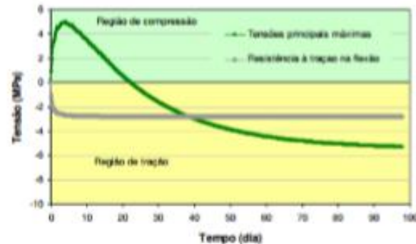
Figura 136: Concreto com partículas de pneu na forma de fibras (CF): Evolução das tensões de origem térmica x resistência à tração do concreto (Elemento 427).
