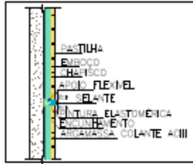
JUNTA DE MOVIMENTAÇÃO HORIZONTAL - JM H
