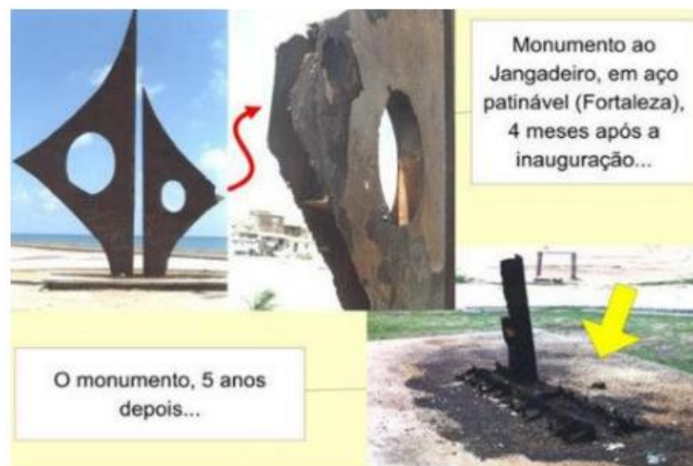
Figura 2 - Monumento exposto a agressividade ambiental em Fortaleza
